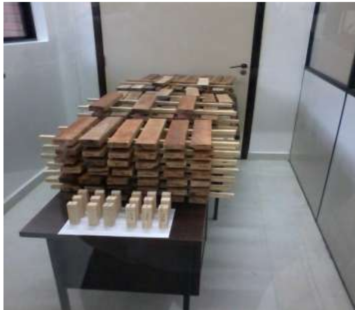
FIGURA 03. SARRAFOS EM CLIMATIZAÇÃO FONTE: O Autor, (2013).
