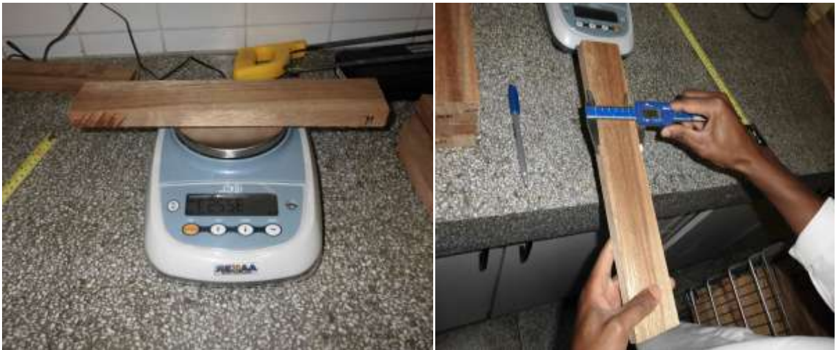
FIGURA 04. MEDIÇÃO DOS SARRAFOS PARA DETERMINAÇÃO DA MASSA ESPECÍFICA APARENTE
