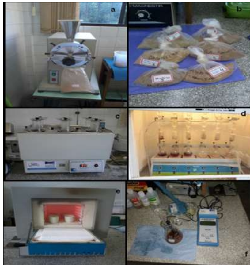
FIGURA 05 - DETERMINAÇÃO DAS PROPRIEDADES QUÍMICAS: a) Moagem dos cavacos; b) Partículas classificadas por espécie; c) Solubilidade; d) Extração; e) Cinzas; f) Medição do pH. FONTE: O Autor, (2013).
