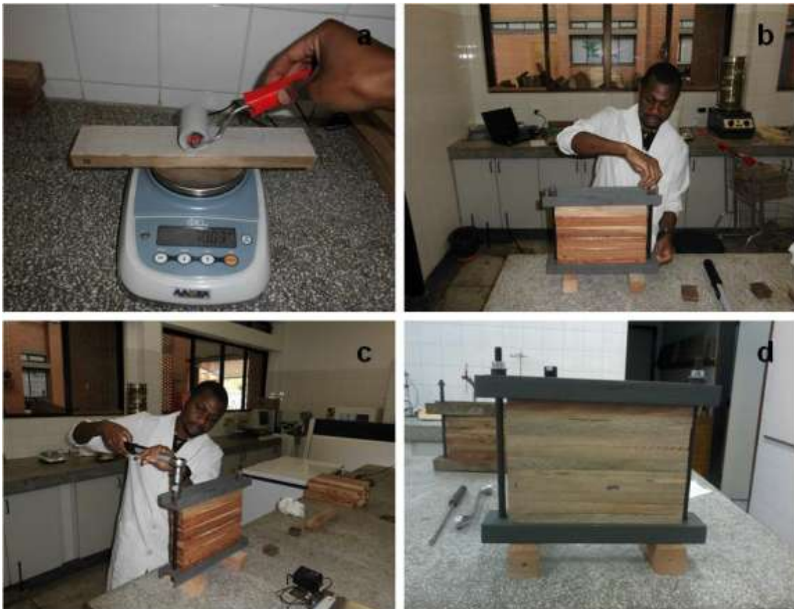
FIGURA 06. ETAPAS DE COLAGEM DOS SARRAFOS: a) Aplicação do adesivo; b) Montagem dos sarrafos; c) e d) Prensagem.
