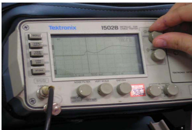
Figura 12. Osciloscópio marca Tektronix, tipo TDR, modelo 1502B.
