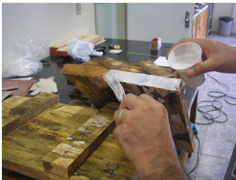
Figura 17. Aplicação de impermeabilizante nos topos das amostras.
