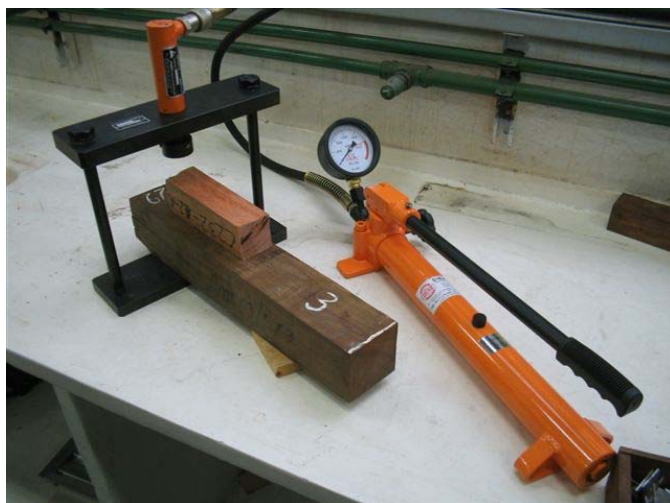
Figura 15 - Durômetro Janka - IPT
