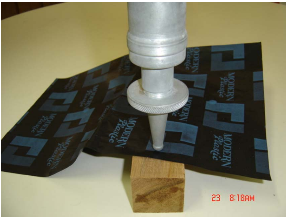
Figura 25 - Esquema geral de endentação da ponteira na madeira, com a utilização de carbono para ressaltar o contorno da calota esférica endentada.
