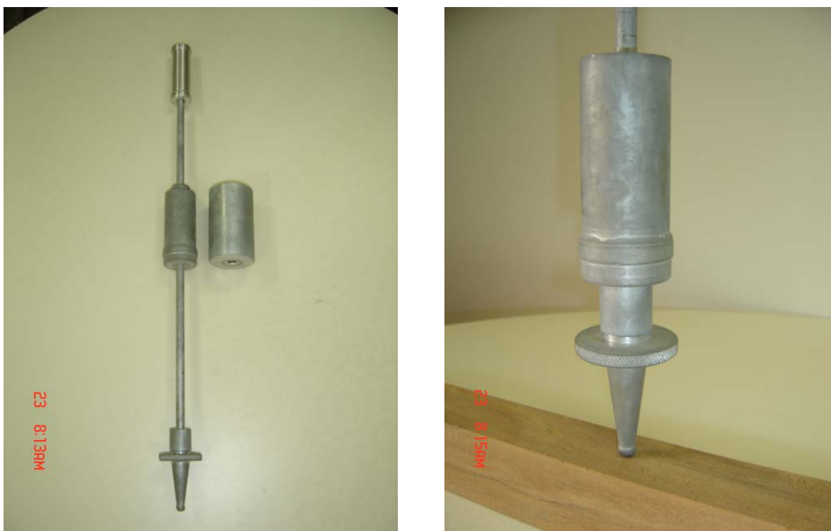
Figura 24 - Vista geral do Durômetro portátil para madeiras (esquerda) e dos detalhes da ponteira (direita).
