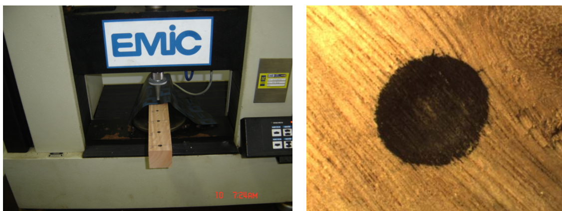
Figura 23 - Endentação no ensaio de dureza Brinell (esquerda) e calota esférica obtida (direita).
