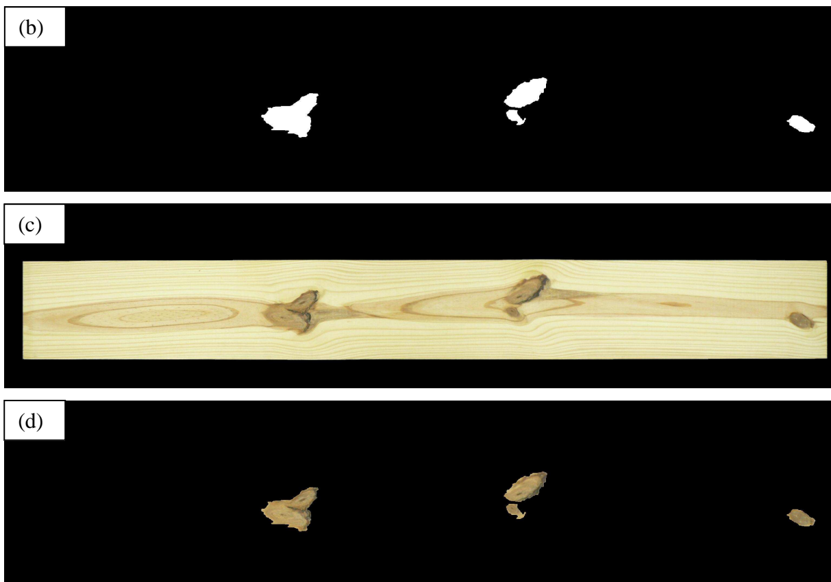
Figura 62 – Segmentação para obtenção da imagem dos nós: a) imagem obtida por crescimento de região; b) imagem binária segmentada por limiarização dos nós; c) imagem original; d) imagem obtida pela operação XOR (imagem binária com imagem original) e pelas operações morfológicas.
