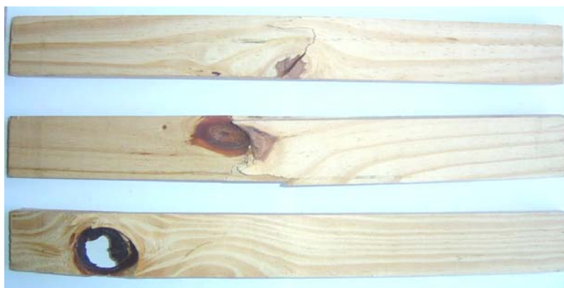
Figura 12 - Corpos-de-prova descartados em função da incidência severa de nós.
