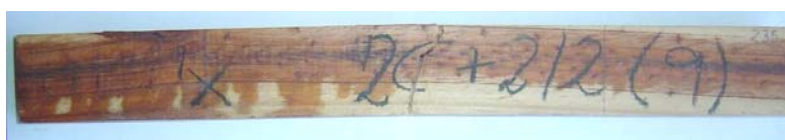
Figura 13 - Corpo-de-prova descartado por apresentar medula.
