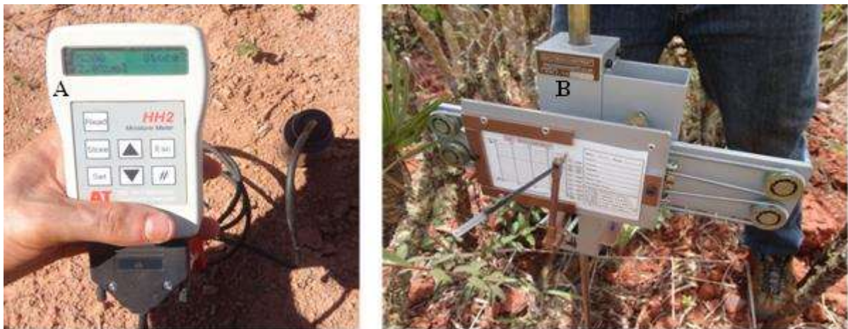
Figura 2: Equipamentos utilizados nas medições de umidade (A) e resistência à penetração (B) em cada parcela alocada na área experimental da pilha de estéril de canga ferruginosa em Conceição do Mato Dentro, MG.
