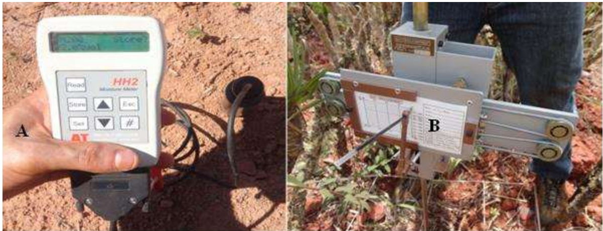
Figura 4: Detalhes dos equipamentos utilizados nas medições de umidade (A) e resistência à penetração (B) em cada parcela alocada na área experimental da fazenda “Passa Sete”, município de Conceição do Mato Dentro, MG.
