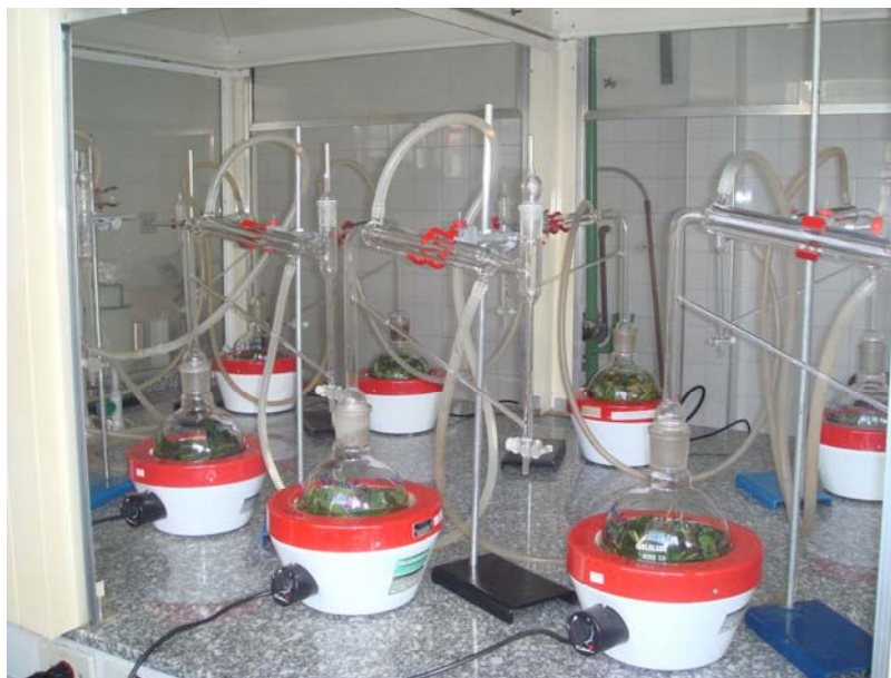
Figura 4. Aparelhos de Clevenger, pertencentes ao Instituto Agrônomo de Campinas, utilizados para a extração dos óleos essenciais.
