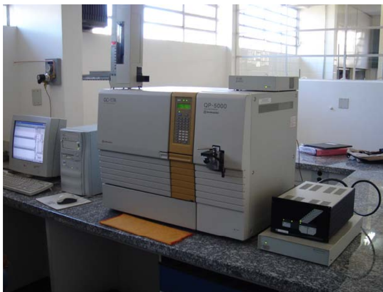
Figura 5. Cromatógrafo à gás, acoplado ao espectro de massas (GCMS), pertencente ao Instituto Agrônomo de Campinas, utilizado para a análise dos óleos essenciais.
