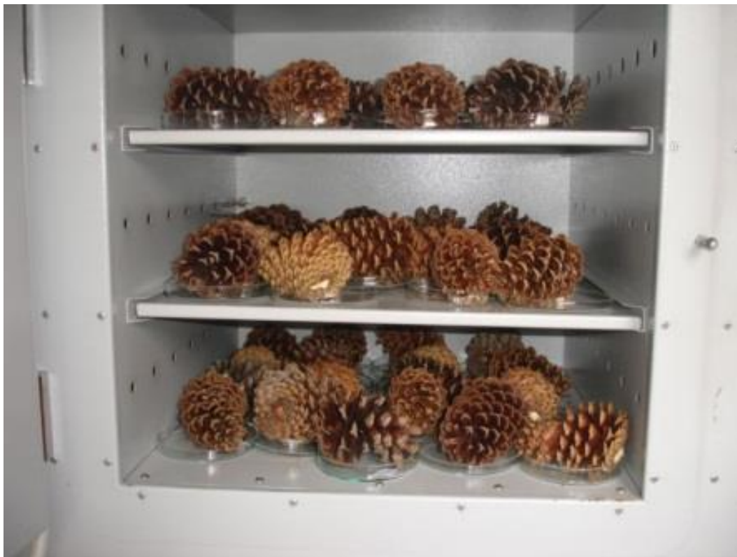
Figura 11: Estufa com as pinhas de pinus, para facilitar a liberação das sementes para análise
