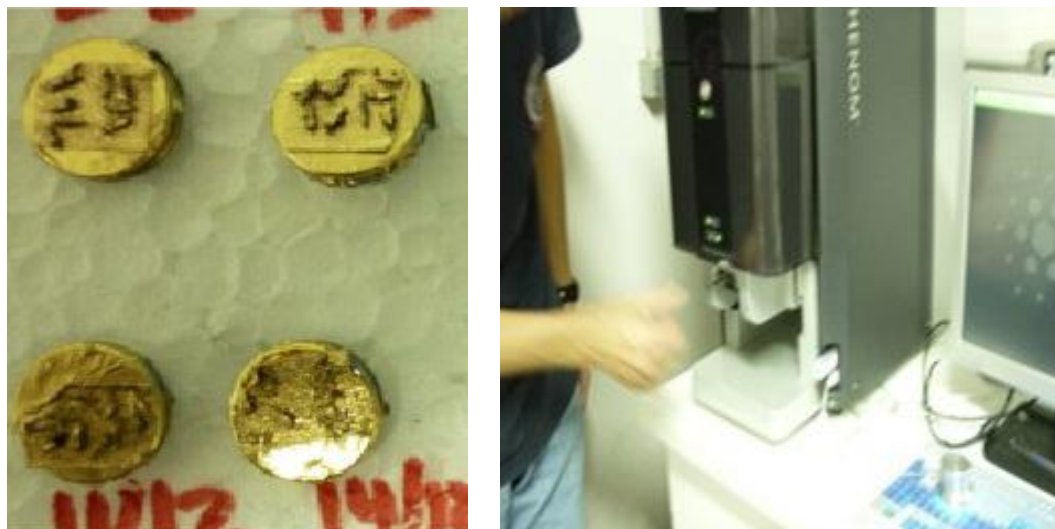
Figura 3. Amostras de T. peregrinus montadas em “stubs” (esquerda) e Microscópio eletrônico de Varredura (MEV) - ESALQ/USP (direita).
