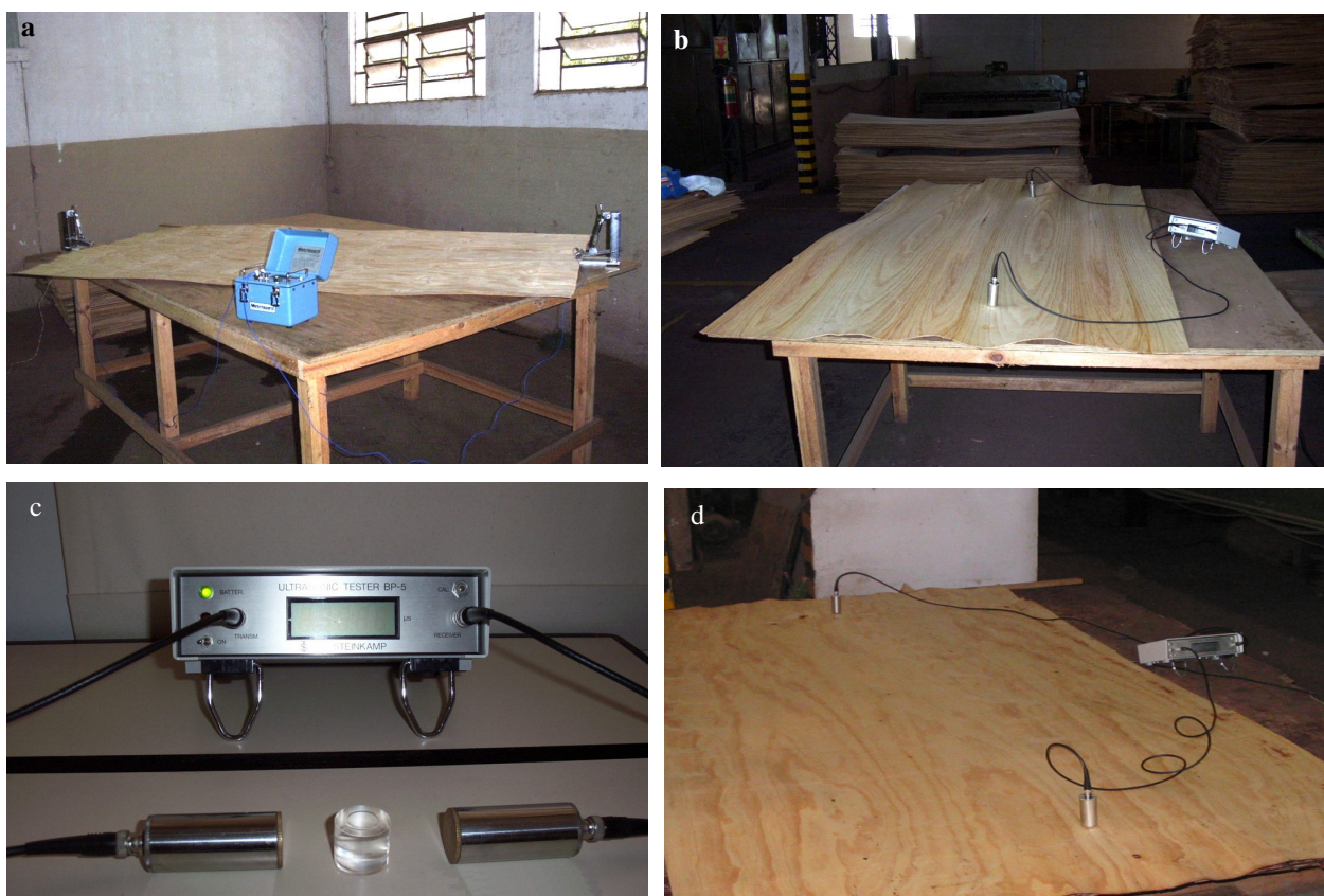
Figura 5 - Ensaios não-destrutivos nas lâminas; a) ondas de tensão - Stress Wave Timer ; b, c e d) equipamento de ultra-som Steinkamp modelo BP-7 e ensaios de ultra-som.
