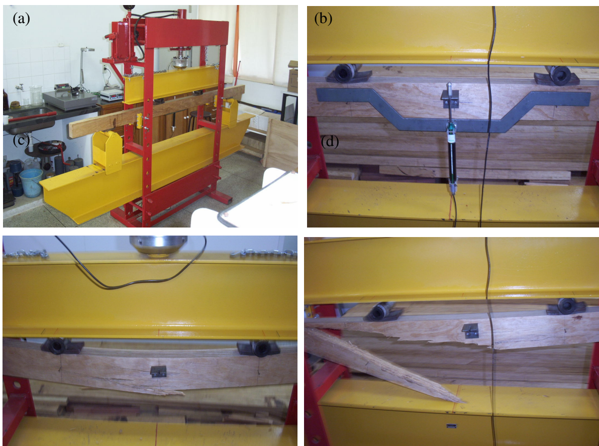
Figura 12 – Painel de 25 lâminas - Ensaio de flexão estática em relação ao eixo de maior inércia – edgewise ; a) no pórtico de ensaios; b) avaliação da deformação da viga; c) viga na iminência da ruptura; d) viga já rompida.
