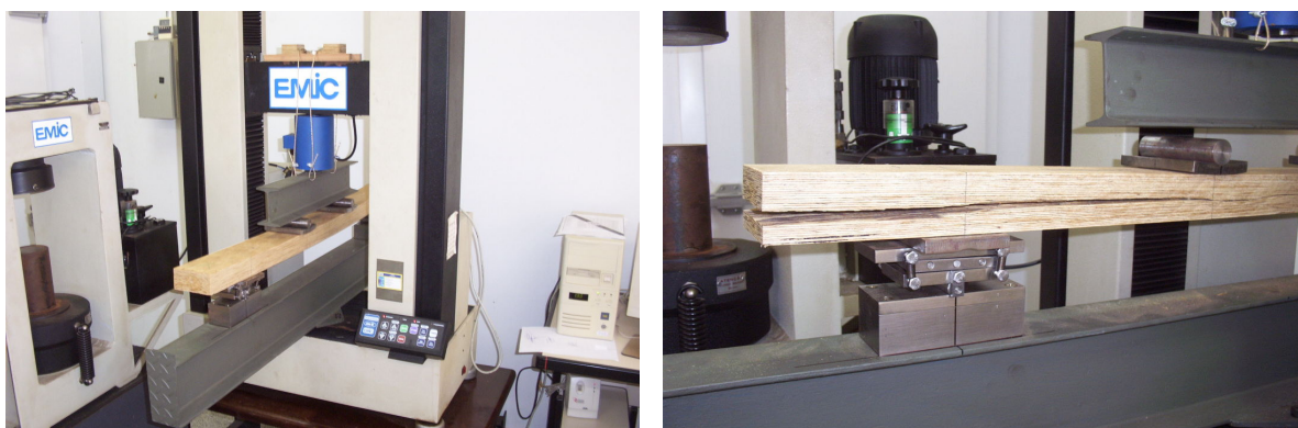
Figura 10 – Painel com 25 lâminas - Ensaio de flexão estática em relação ao eixo de menor inércia.
