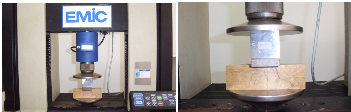
Figura 14 – Painel de 25 lâminas - Ensaio de compressão perpendicular às fibras.
