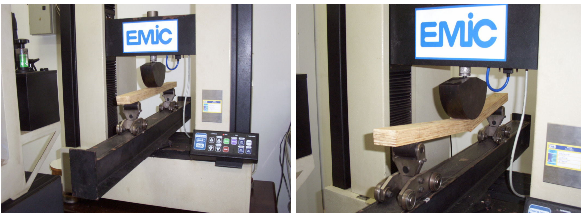
Figura 11 - Painel com 13 lâminas - Ensaio de flexão estática (c.p. longitudinal) em relação ao eixo de menor inércia.
