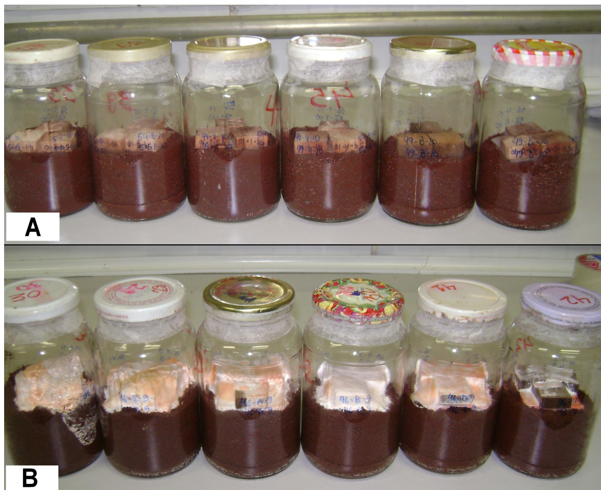
Figura 14. Início do ensaio de apodrecimento acelerado do tipo “soil-block”, para as madeiras de E. grandis (A) e após 12 semanas de incubação (B).
