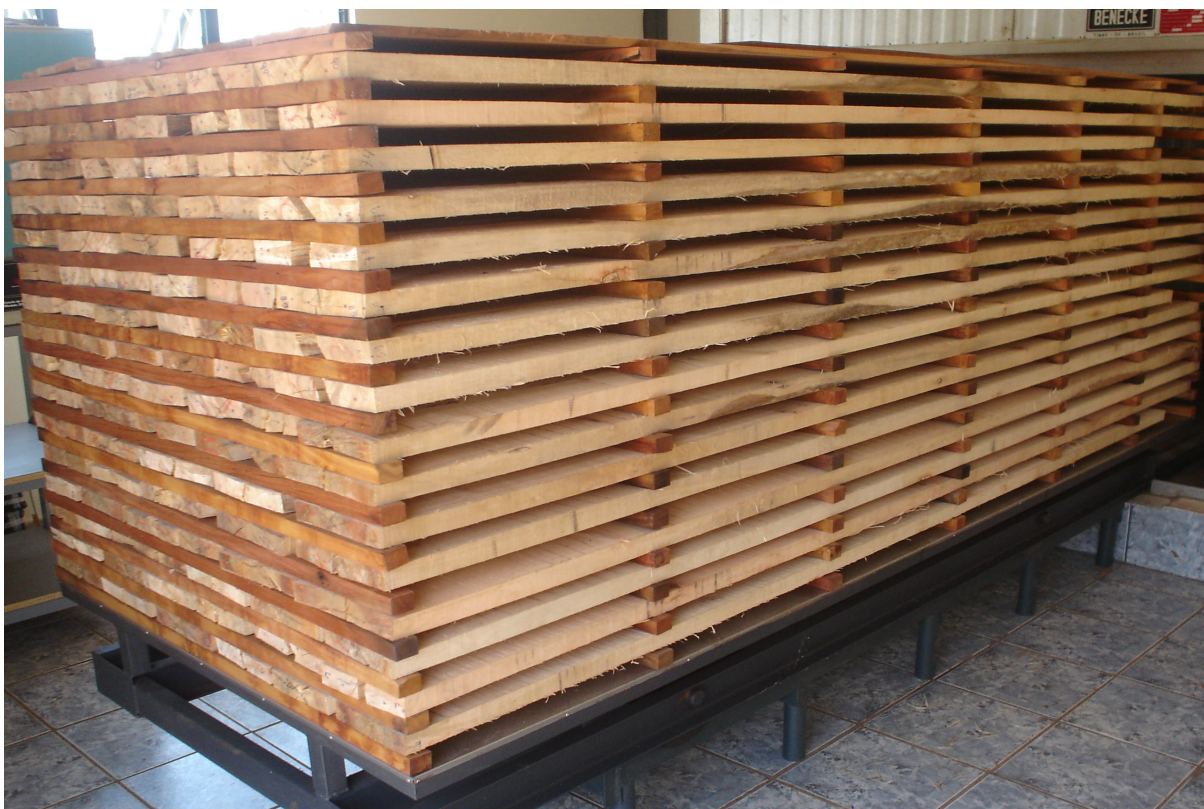
Figura 7. Empilhamento da madeira de Eucalyptus grandis Hill ex Maiden para a sua secagem convencional.
