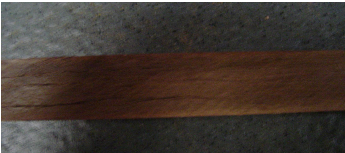
Figura 1-1: Rachaduras internas ao longo das tábuas de Eucalyptus grandis termorretificadas com temperaturas de 200°C durante 3 horas.
