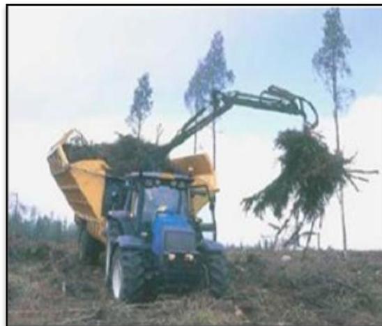
Figura 7. Extração de resíduo utilizando caçamba compactadora - Havu-Hukka.
