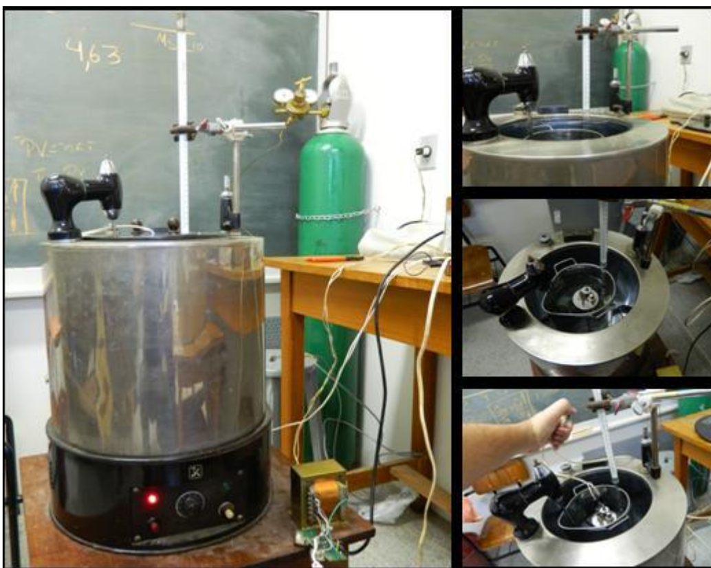
Figura 29. Calorímetro utilizado para determinação do poder calorífico superior (PCS).
