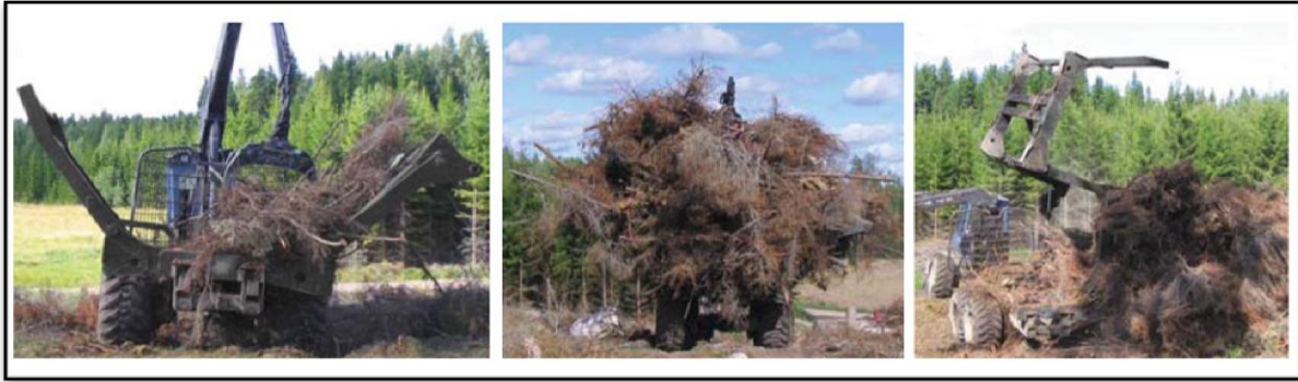
Figura 8. Extração de resíduos com carregamento (esquerda), Transporte (centro) e descarregamento (direita).
