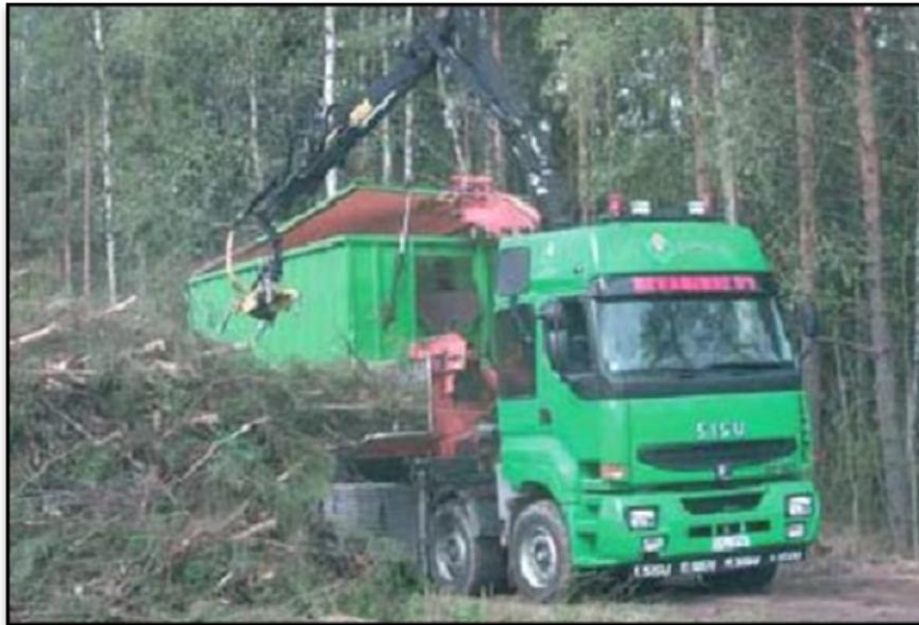
Figura 11. Caminhão com capacidade de realizar a preparação de cavacos dos resíduos e o transporte até a planta de energia (SISU CHIPPER).
