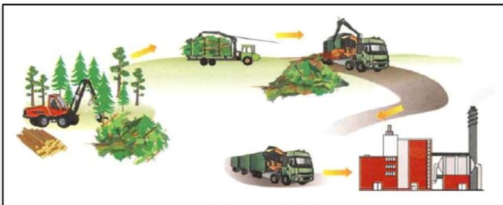
Figura 10. Sistema de preparação de cavacos nas margens de estradas com utilização do caminhão SiSU CHIPPER.
