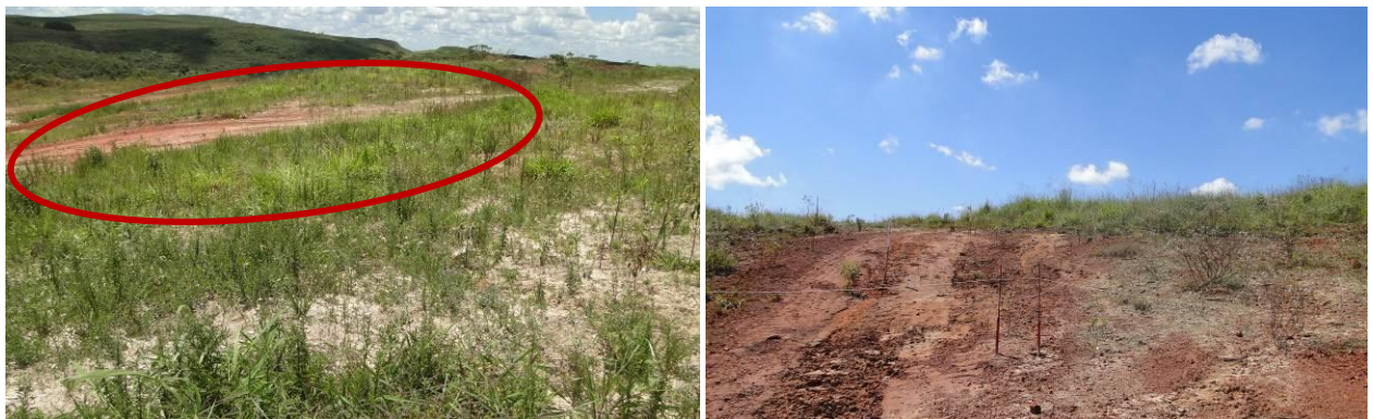
Foto: Detalhamento do carreamento do topsoil referente ao tratamento T3 do bloco 3, pela água da chuva, devido a inclinação dessa área.
