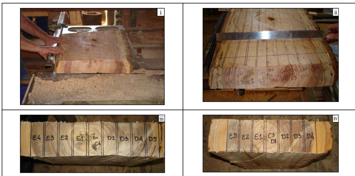
Figura 10 – Etapas da produção do material para as análises. (i): prancha central cujo desdobro originou todos os corpos-de-prova para a determinação das características anatômicas e propriedades físico-mecânicas. (ii) prancha central de E. grandis , evidenciando as demarcações feitas para o corte das faixas diametrais e dos caibros. (iii) prancha central de Corymbia (Eucalyptus) citriodora de onde puderam ser serrados nove caibros. (iv) prancha central de Corymbia (Eucalyptus) citriodora de onde puderam ser serrados sete caibros. E e D referem-se, respectivamente, às regiões da esquerda e da direita da medula.
