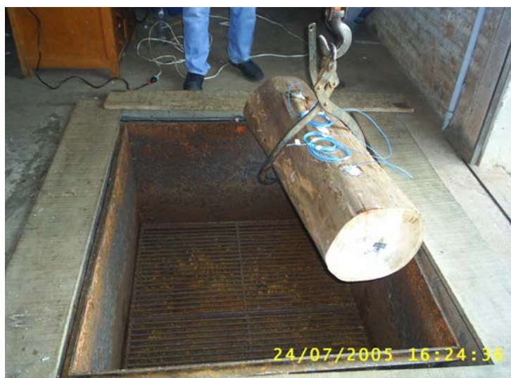
Figura 14. Sistema utilizado para acomodação das toras no tanque.
