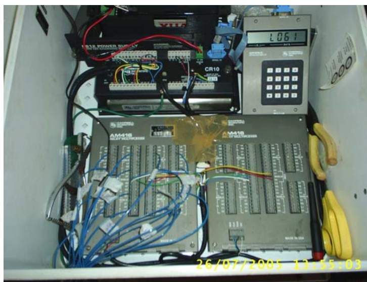
Figura 15. Figura do sistema utilizado para o acoplamento dos termopares no equipamento de aquisição de dados, datalogger (Campbell Scientific - CR10).
