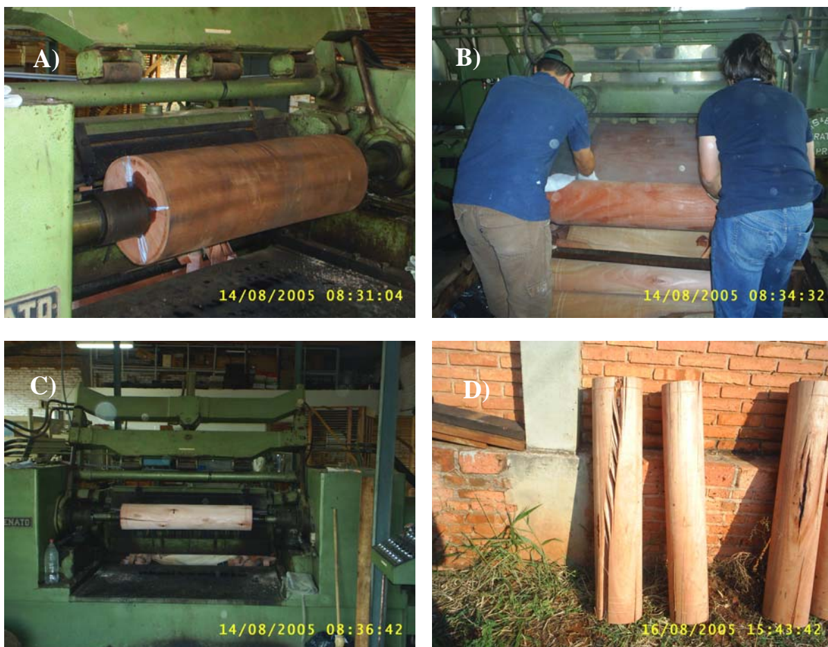
Figura 17. Desenrololamento das toras após o tratamento térmico: A) Tora arredondada; B) Lâminas sendo enrolada em uma bobina “carretel”; C) Final da laminação e D) Rolos-resto retirados
