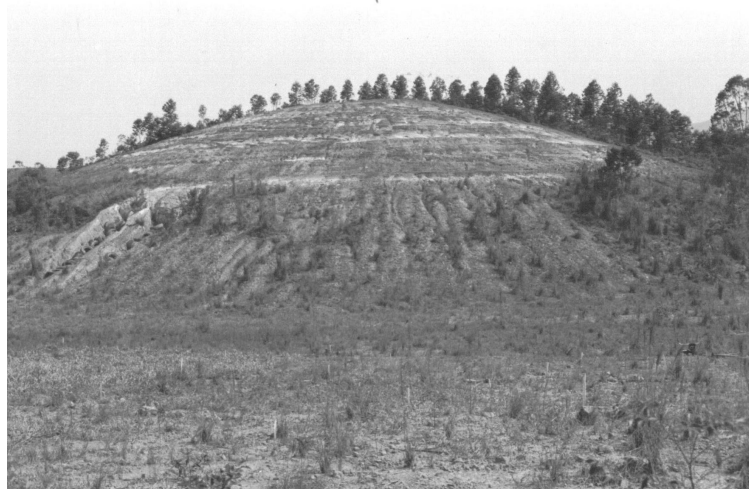
Figura 2. Vista do morro decapeado após a retirada de solo utilizado para a recomposição da área onde houve exploração de carvão em Lauro Müller - SC.
