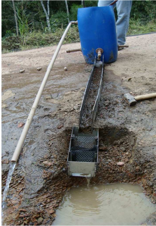
Figura 5.3. Simulador de escoamento superficial em canal
