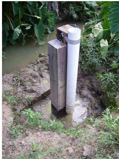
Figura 2.3. Amostrador de nível ascendente e nível descendente instalado no ponto 1
