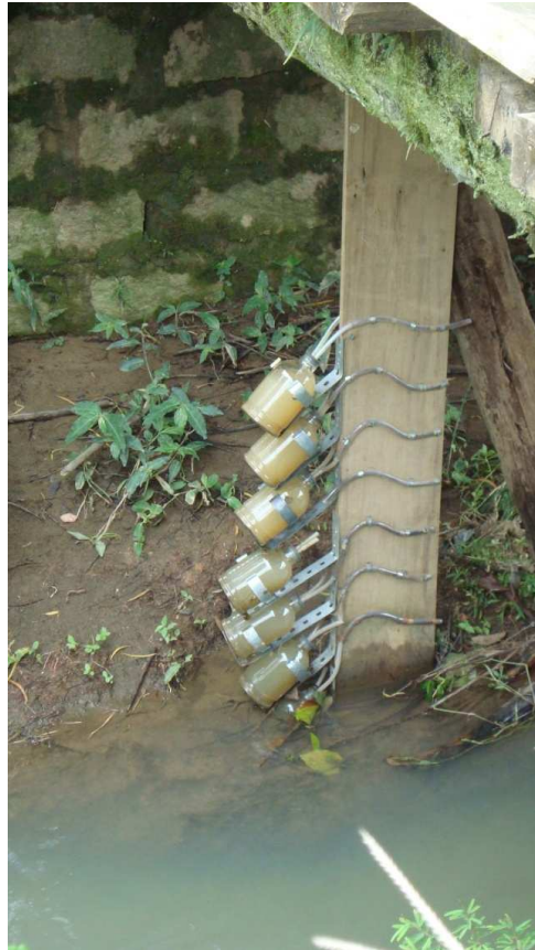
Figura 2.4. Amostrador de nível ascendente instalado no ponto 2 da bacia
