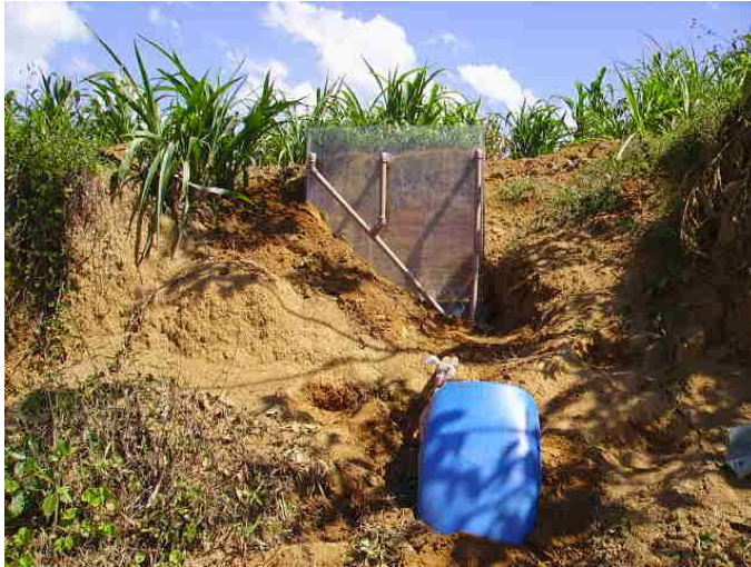
Figura 2.7. Coletores de escoamento superficial e sub-superficial do lisímetro instalado na bacia do Ribeirão Concórdia
