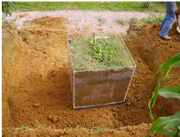
Figura 2.6. Lisímetro volumétrico instalado na Bacia Ribeirão Concórdia
