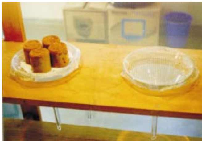
Figura 1. Detalhe do extrator: à direita o funil com a tela de arame e à esquerda com a gaze e quatro anéis com solo.
