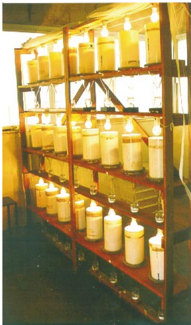
Figura 3. Estante extratora em operação, com 24 extratores em três prateleiras.
