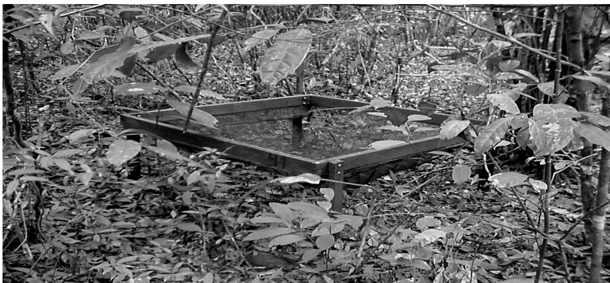
Figura 4 - Coletor de liteira no tratamento controle, instalado 30 cm acima da superfície do solo, em floresta sucessional, Castanhal/PA.
