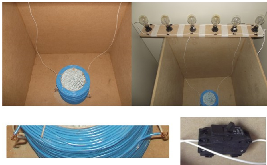
FIGURA 15 – Eletroímã instalado no interior da caixa de teste. Fonte: Autor, 2012.
