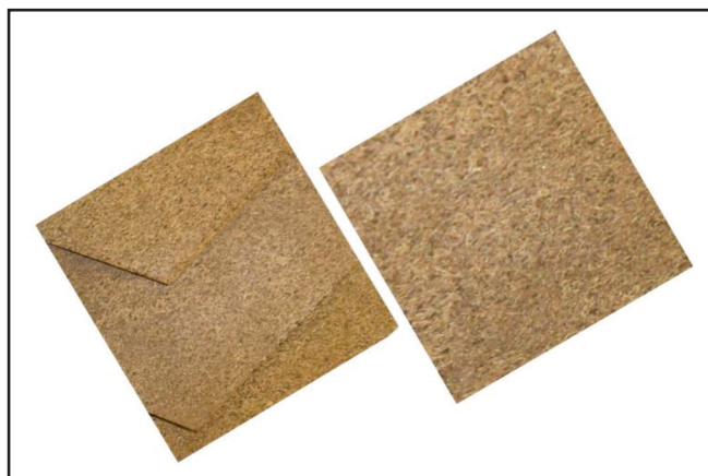
Figura 2. Painéis elaborados com resíduos da casca de coco-verde.
