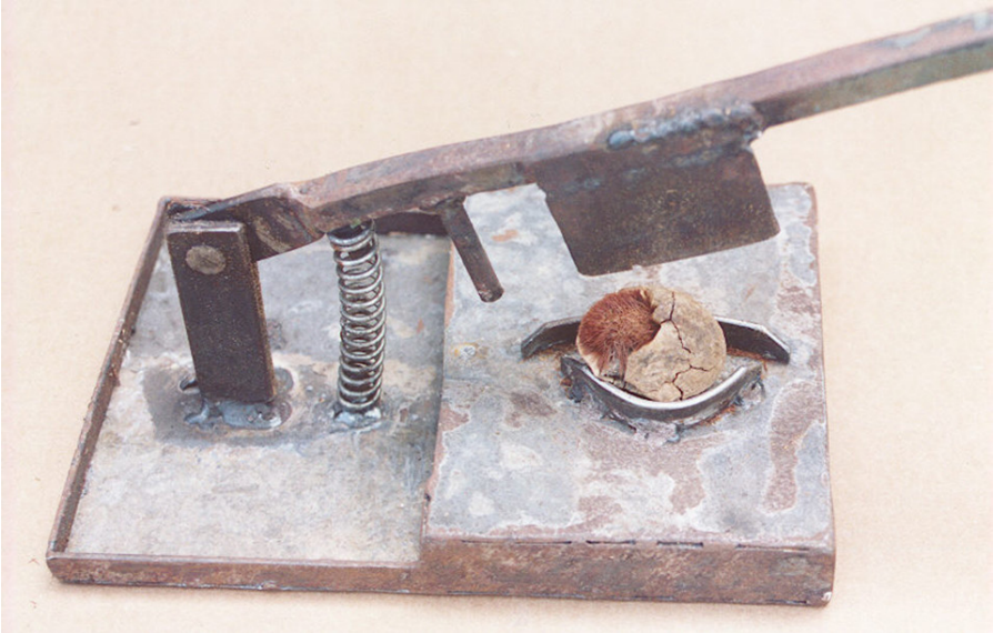
Fig. 3. Utilização de um descascador artesanal de castanha-do-brasil para remoção da porção espinescente do endocarpo de pequiá.
