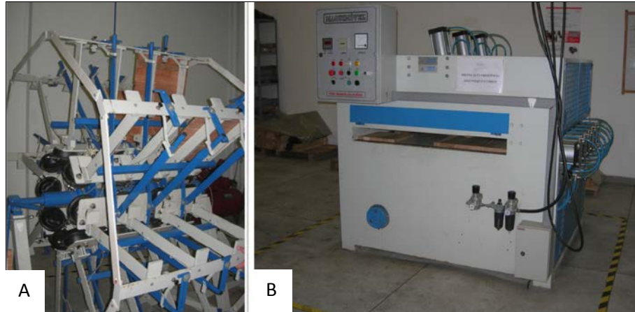
FIGURA 04. PRENSAS UTILIZADAS PARA AS COLAGENS. A - CARROSSEL. B - ALTA FREQUÊNCIA. FONTE: A autora (2012)
