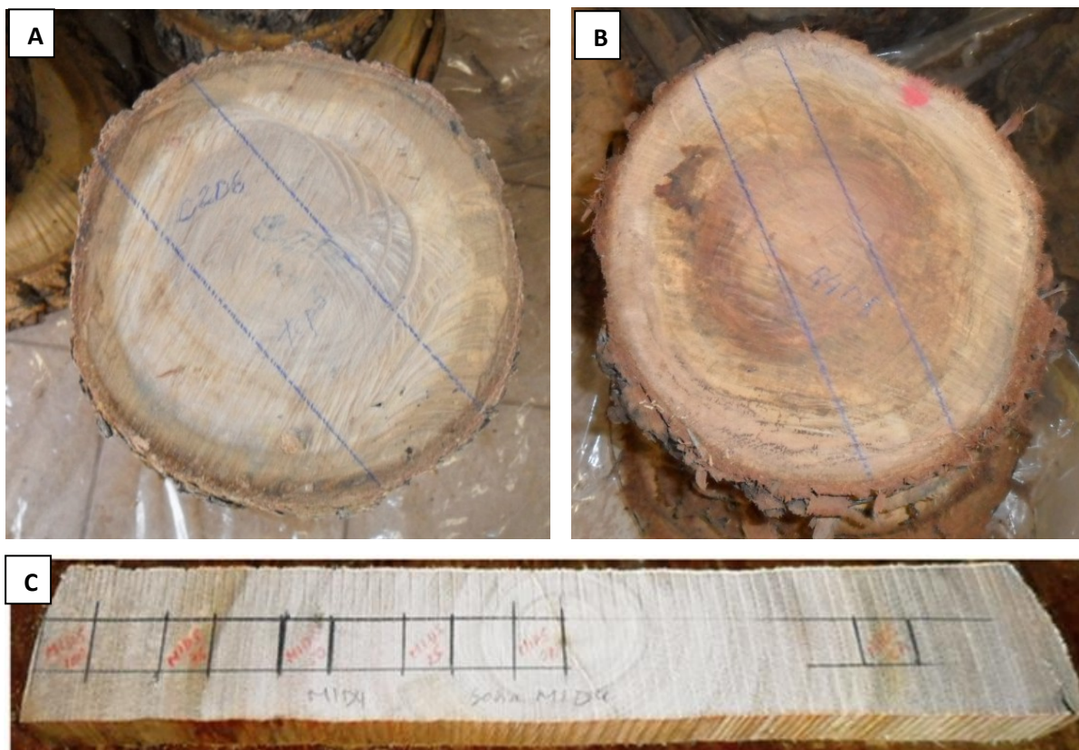
Figura 5 - Seção transversal dos discos de lenho das árvores de Eucalyptus cloeziana (A) e E. resinifera (B) e demarcação das amostras diametrais; (C) demarcação das amostras radiais na seção transversal e do corpo de prova de madeira para a caracterização anatômica
