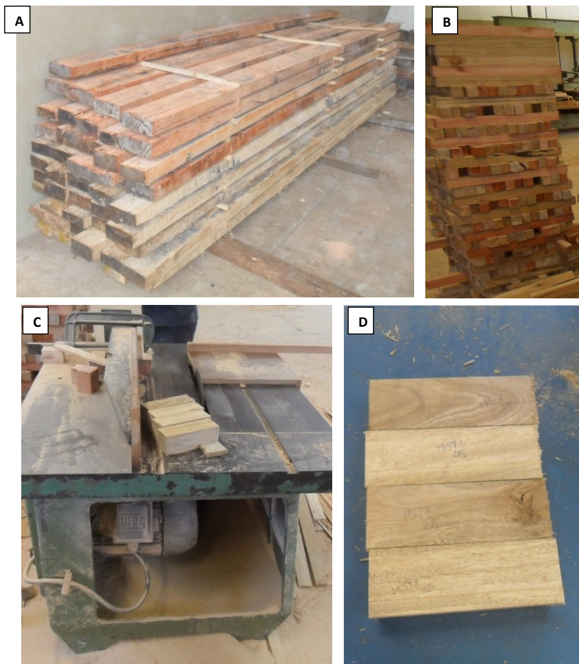
Figura 7 - Vigas de madeira armazenadas para a redução da umidade e alívio de tensões (A), caibros selecionados para confecção dos corpos de prova de madeira (B), corpos de prova de madeira (C, D)
