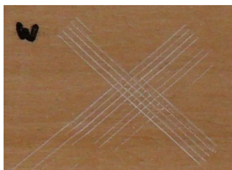
Figura 20 - Ensaio de aderência do filme na superfície da madeira de E. cloeziana
