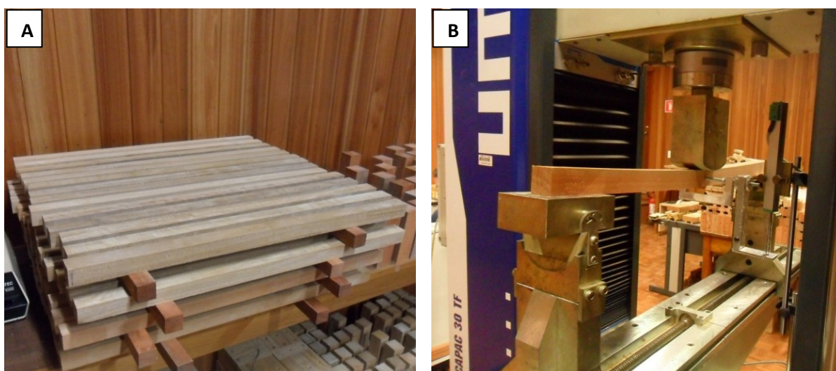
Figura 11 - Corpos de prova de madeira estabilizados (A) e ensaio de flexão estática da madeira (B)
