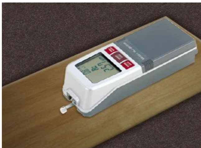
Figura 17 - Ensaio de corpo de prova de madeira com equipamento rugosímetro
