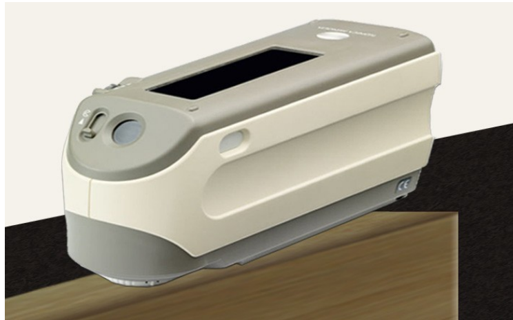
Figura 9 - Leitura de espectros da madeira de Corymbia maculata com espectrofotômetro
