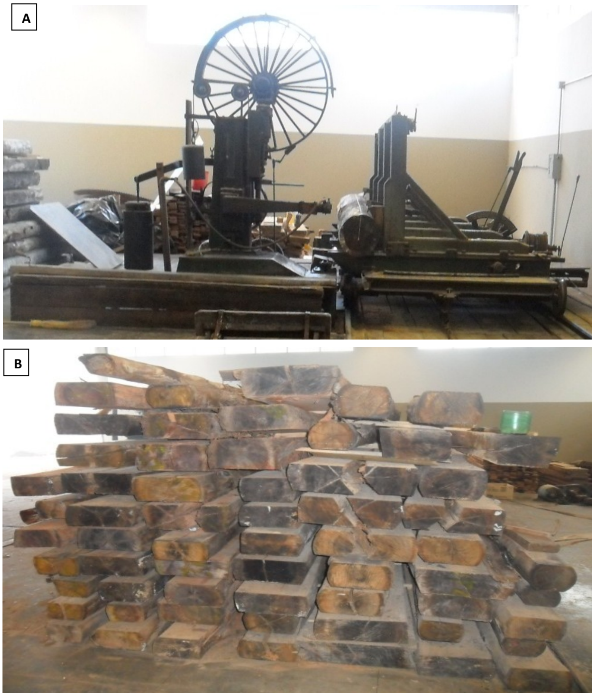
Figura 6 - Tora do tronco de árvore fixada no carro da serra fita e seu desdobro em pranchões de madeira (A); pranchões de madeira provenientes do desdobro de tora (B)
