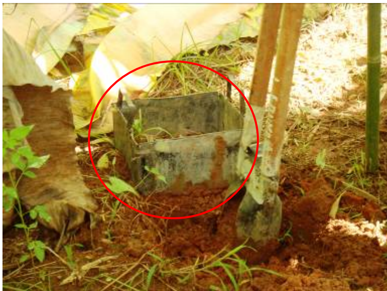
Figura 30. Coletor metálico de amostras para extração de fauna do solo
