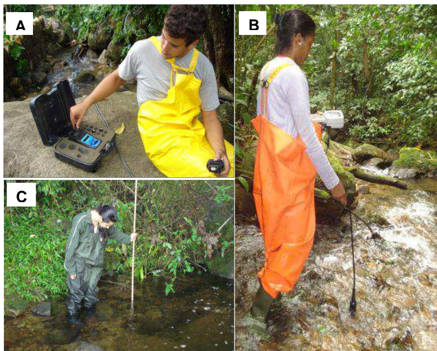
Figura 4: Medição de variáveis físicas e químicas em riachos de Floresta Atlântica, bacia da Baía de Guanabara, nos períodos de seca dos anos de 2010 e 2011. A – turbidez; B- temperatura da água, oxigênio dissolvido e condutividade; C – profundidade, velocidade da corrente e tipo de substrato.
