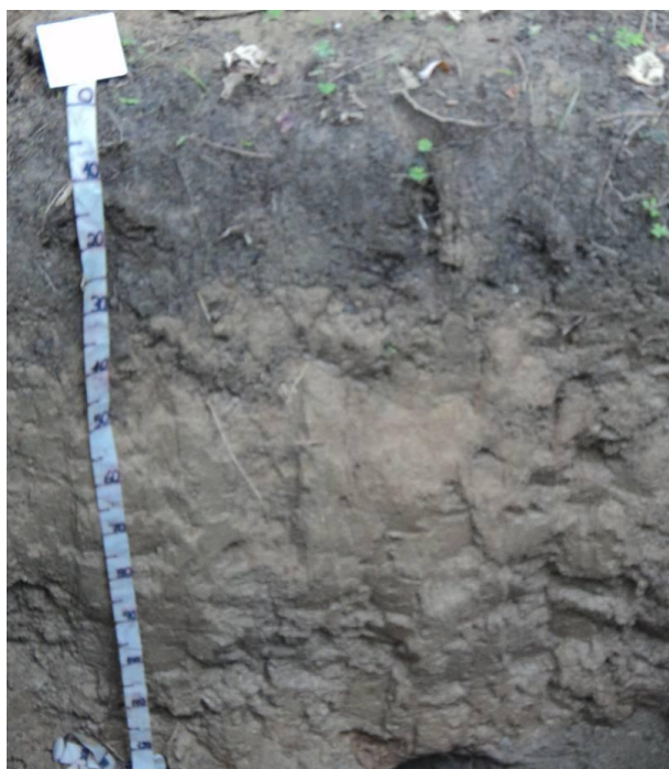
Figura 14: Perfil do Cambissolo Háplico Ta Eutrófico, encontrado na área 3 da SFE – UTE Barbosa Lima Sobrinho, em Seropédica, RJ.
