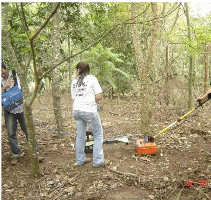
Figura 8: Utilização do GRP para leitura da profundidade do lençol freático na área de reflorestamento da SFE – UTE Barbosa Lima Sobrinho, em Seropédica, RJ.
