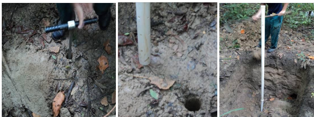
Figura 9: Instalação do poço de observação para leitura da profundidade do lençol freático na área de reflorestamento da SFE – UTE Barbosa Lima Sobrinho, em Seropédica, RJ.
