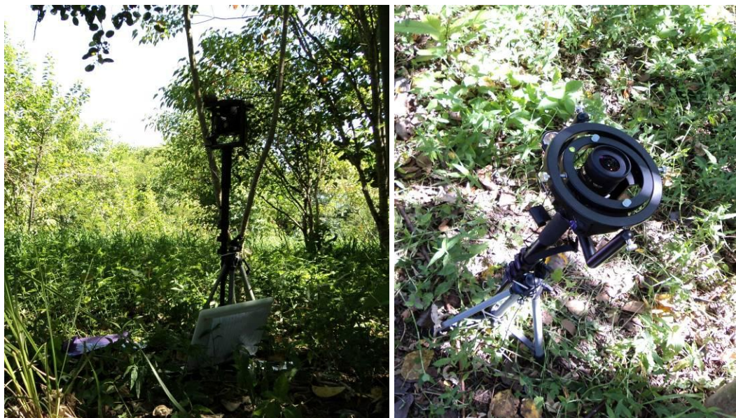
Figura 11: Equipamento para captura das fotografias hemisféricas na área de reflorestamento da SFE – UTE Barbosa Lima Sobrinho, em Seropédica, RJ.
