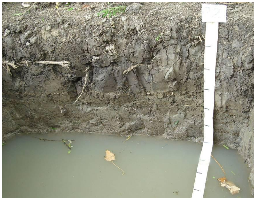
Figura 13: Perfil do Gleissolo Háptico Tb Distrófico neofluvissólico, encontrado na área 2 da SFE – UTE Barbosa Lima Sobrinho, em Seropédica, RJ.
