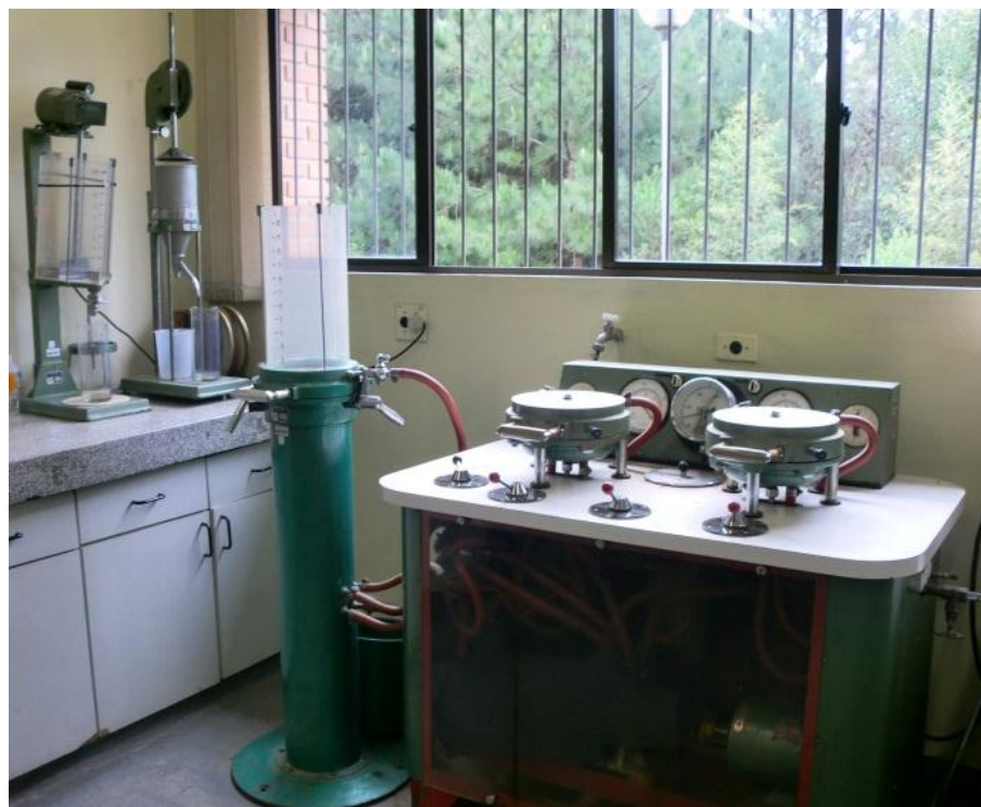
FIGURA 9 - ESTAÇÃO FORMADORA RAPID-KÖETHEN Fonte: A autora, 2011
