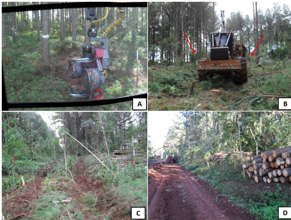
Figura 6 – Passagem do harvester nas parcelas CP (A); Passagem do forwarder carregado (B); Aspecto da parcela após a passagem das máquinas (C) e formação do Estaleiro (D).
