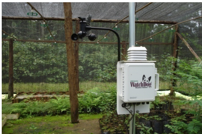
Figura 3 – Foto da estação metereológica e o sistema de irrigação por microaspersão nas casas de vegetação, instalados nas casas de vegetação, localizadas na área da EMBRAPA AGROBIOLOGIA.
