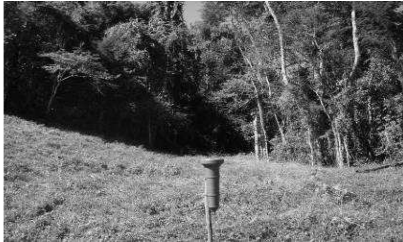
Figura 9. Pluviômetro instalado fora das áreas de estudo para a quantificação da precipitação total.
