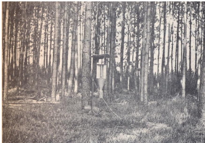
FIGURA 1 - Armadilha luminosa usada na coleta de insetos noturnos.
