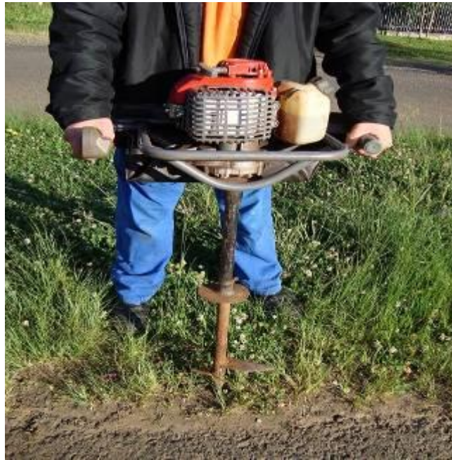
Figura 04. Moto coveador utilizado na abertura da cova.
