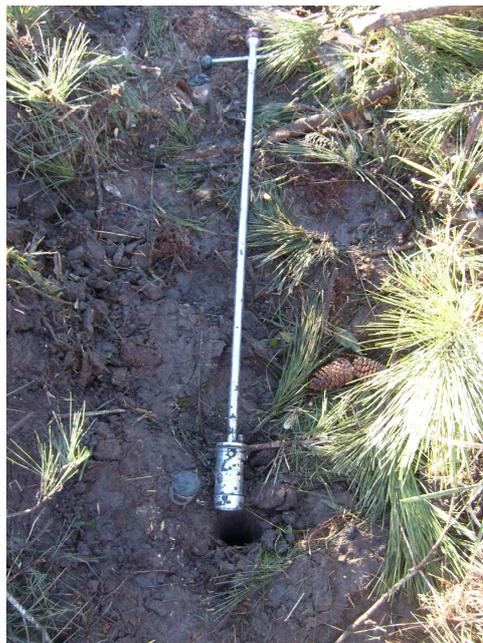
**Figura 6.** Trado para amostras indeformadas (TAI), marca *Soil Control*.
