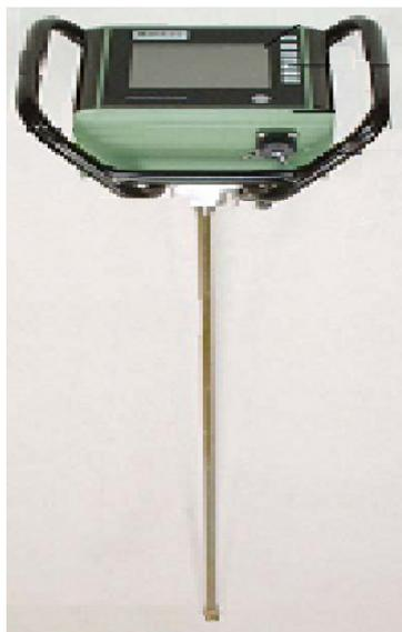
**Figura 7.** Penetrógrafo eletrônico digital, marca *Eijkelkamp*.
