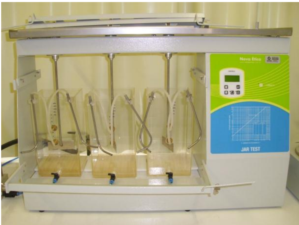
Figura 4.3. Equipamento Flotateste utilizado na pesquisa.
