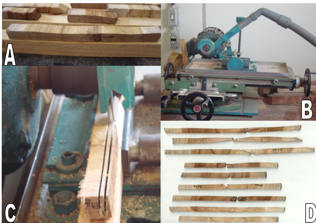
Figura 11. Preparo do material para densitometria de raios X. A – Colagem da amostra no suporte de madeira; B – Equipamento dupla serra circular paralela; C – Detalhe do corte para retirada da amostra com 2 mm de espessura; D – material para climatização.
