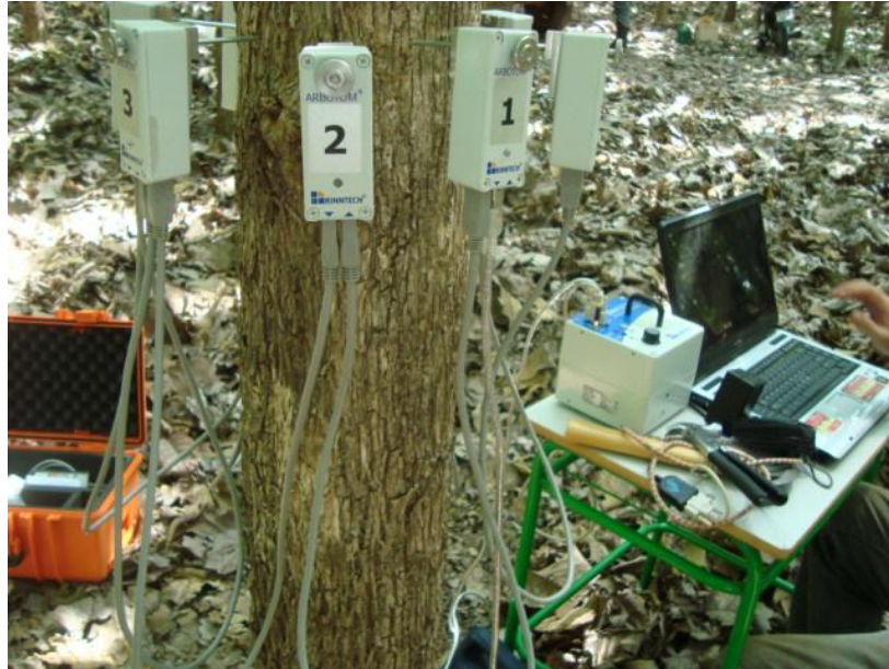
Figura 7. Utilização do Tomógrafo de impulso ARBOTOM para obtenção das imagens tomográficas.
