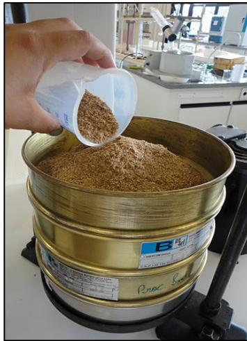
Figura 4. Jogo de peneiras para classificação granulométrica.
