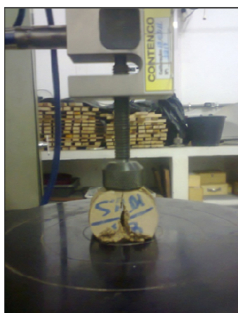
Figura 12. Ensaio de resistência à tração por compressão diametral.
