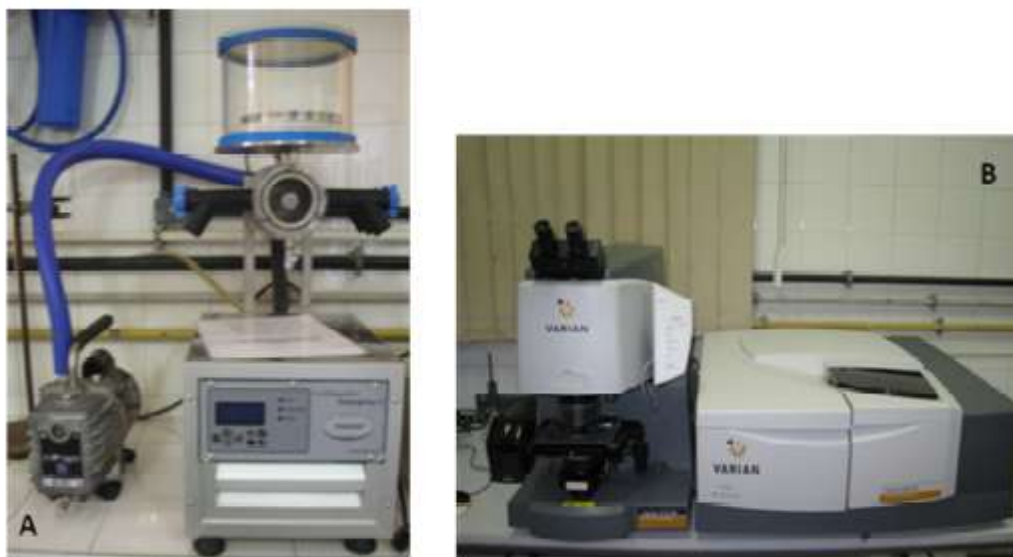
Figura 11. Liofilizador (TERRONI – Modelo ENTERPRISE) (A) e Espectrômetro de infravermelho VARIAN 640-IR acoplado ao microscópio FTIR (B) (OLIVEIRA, 2010).
