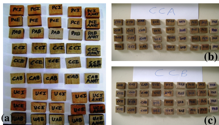
Figura 11 – (a) Madeira sem tratamento; (b) madeira tratada com CCA; (c) madeira tratada com CCB.
