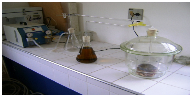
Figura 3 - Método de impregnação dos corpos-de-prova adaptado da ASTM D - 1413 (1994).
