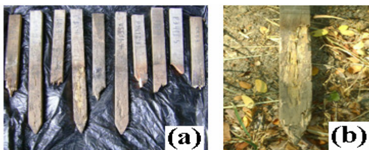
Figura 16 - Campo de Apodrecimento 2 (a) estacas deterioradas; (b) estaca deteriorada por térmitas.
