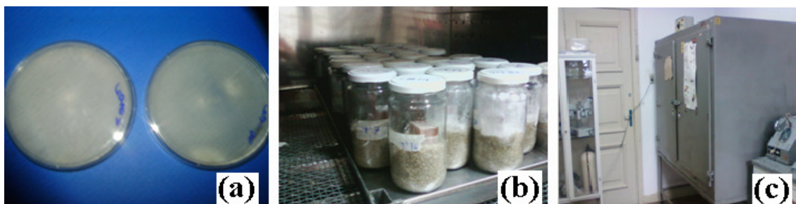
Figura 2 – (a) Placa de petri contendo o fungo Postia placenta ; (b) ensaio de durabilidade natural; (c) câmara climatizada.
