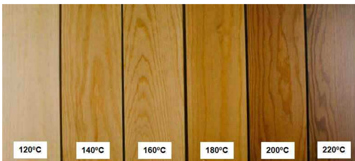
Figura 6. Alteração da cor da madeira de Pinus sylvestris L. após a termorretificação entre 120 e 220°C (Fonte: THERMOWOOD HANDBOOK, 2003).
