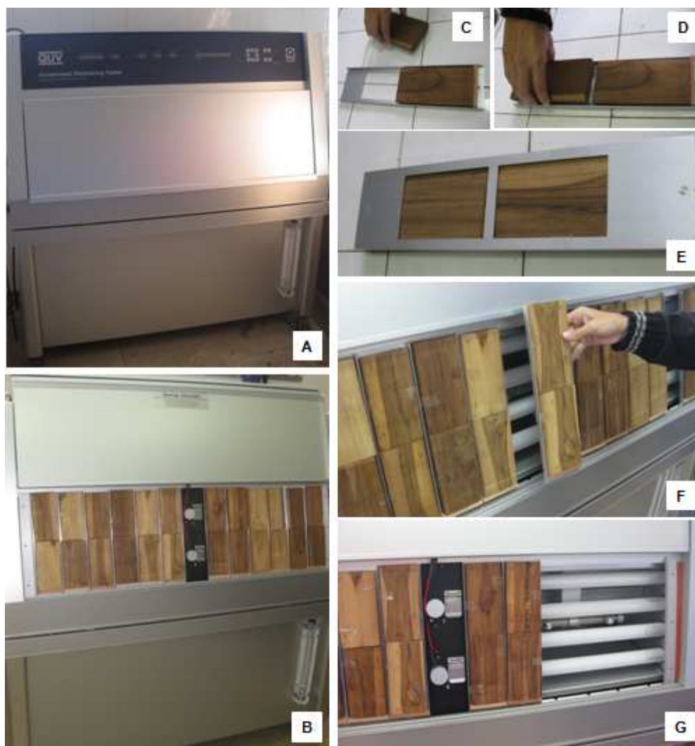
Figura 26. Ensaio de envelhecimento acelerado. (A) Câmara de envelhecimento acelerado QUV, marca Q-Lab, modelo QUV/Spray. (B) Disposição das amostras de madeira na câmara de envelhecimento. (C)-(F) Fixação das amostras de madeiras no porta amostra. (G) Posicionamento das amostras com relação às lâmpadas UVA-340.
