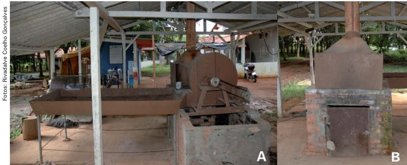
Figura 2. Secador a ar forçado aquecido artificialmente (SAAA) com vista de fundo do secador (A) e vista frontal da fornalha com a coifa (B).
