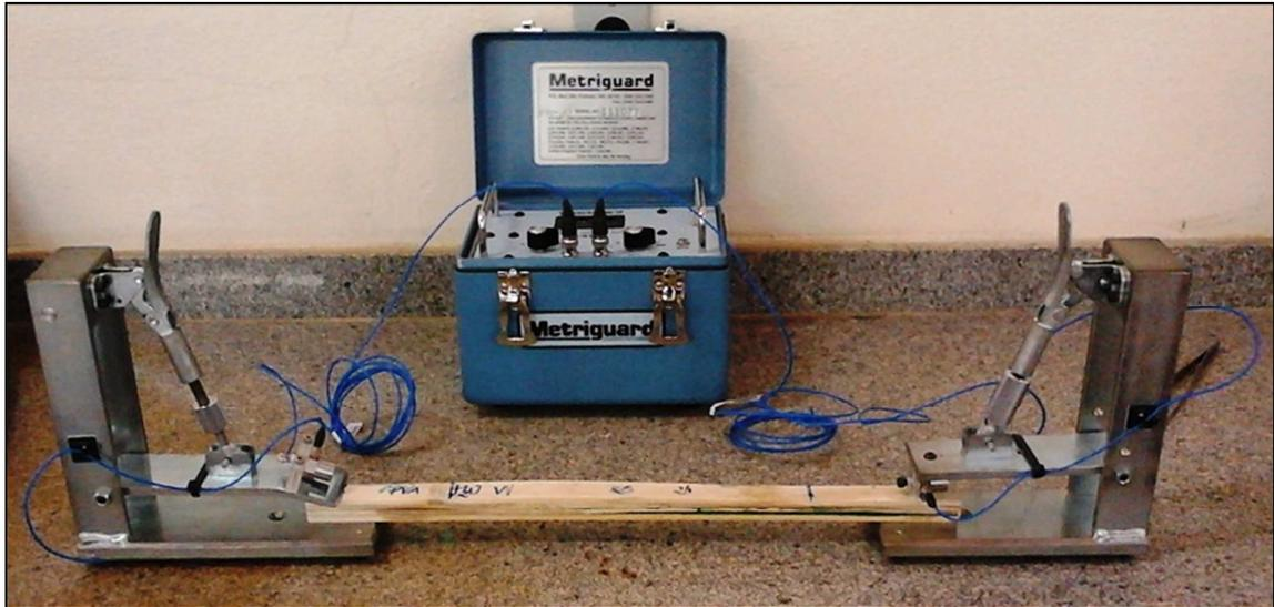
Figura 11. Ensaio do MOE dinâmico pelo método do *Stress Wave*.
