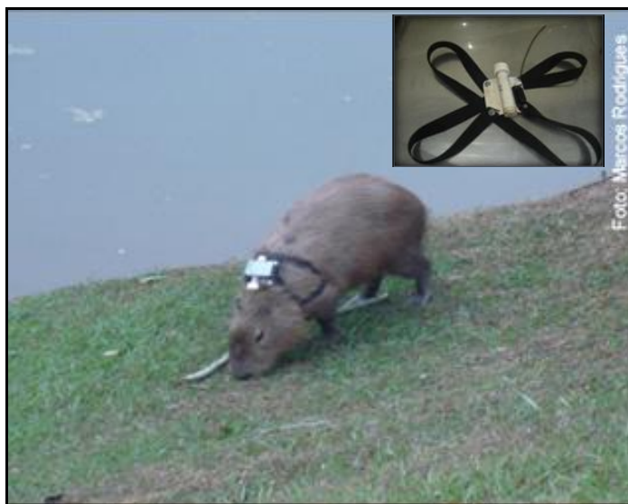
Figura 5: Colete peitoral confeccionado com fita de nylon trançado contendo fragmento de tubo de PVC como dispositivo de liberação lenta e contínua de carrapaticida em capivara do campus da UFV.
