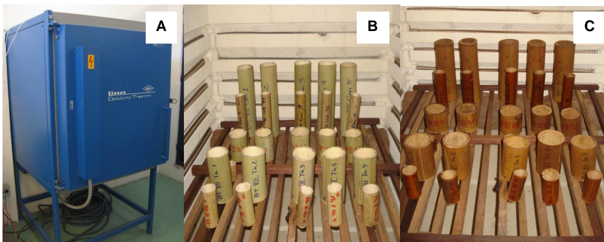
Figura 11. A) Mufla elétrica laboratorial. B) Disposição das amostras no interior da mufla antes do tratamento de termorretificação. C) Disposição das amostras no interior da mufla depois do tratamento de termorretificação.
