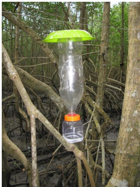
Figura 4. Armadilha de impacto modelo Carvalho-47 instalada em área de mangue. Santa Cruz-RJ, 2011.
