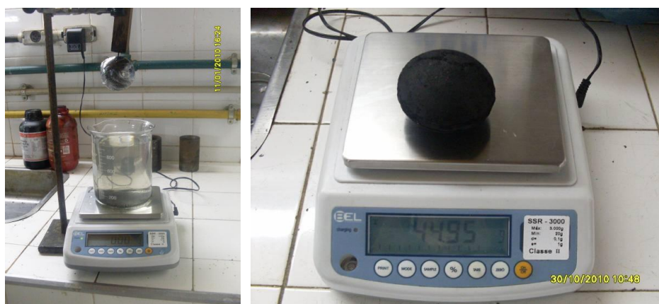
Figura 10. Medição do volume e massa dos briquetes para determinação da densidade aparente.
