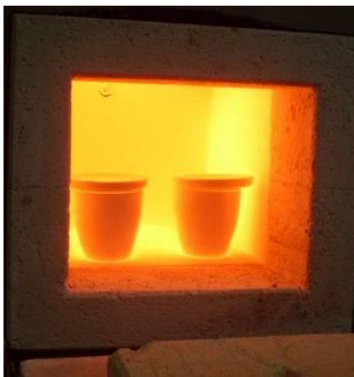
Figura 13. Mufla utilizada ao longo da análise química imediata contendo os cadinhos com as amostras dos briquetes.
