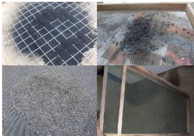
Figura 15. Peneiras com malhas de diferentes tamanhos utilizadas na avaliação do tamboramento dos briquetes.
