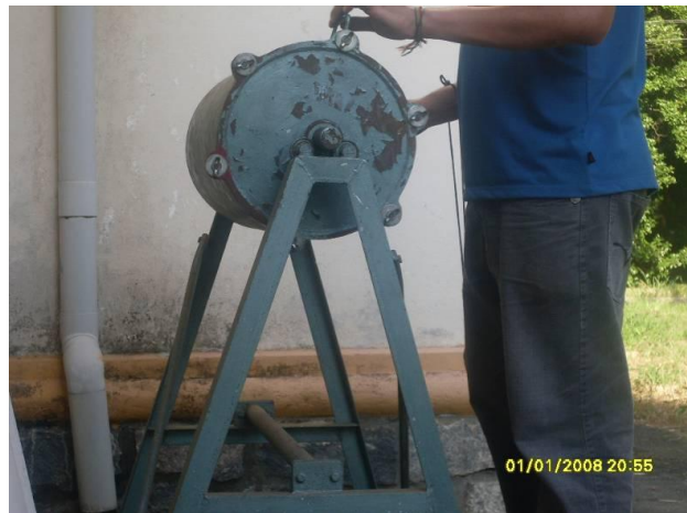
Figura 14. Tambor rotativo utilizado nos ensaios de tamboramento.
