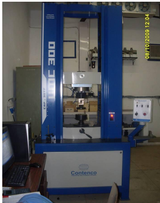
Figura 11. Máquina universal de ensaios Contenco UMC 300.
