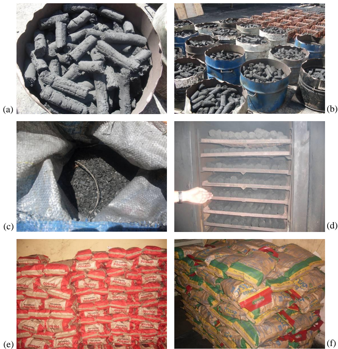
Figura 4. Detalhes da produção de briquetes de carvão vegetal da empresa Eco-briquetes, de Volta Redonda/RJ. (a) e (b) briquetes após secagem; (c) moinha de carvão; (d) secagem em estufa; (e) e (f) empacotamento e estocagem.
