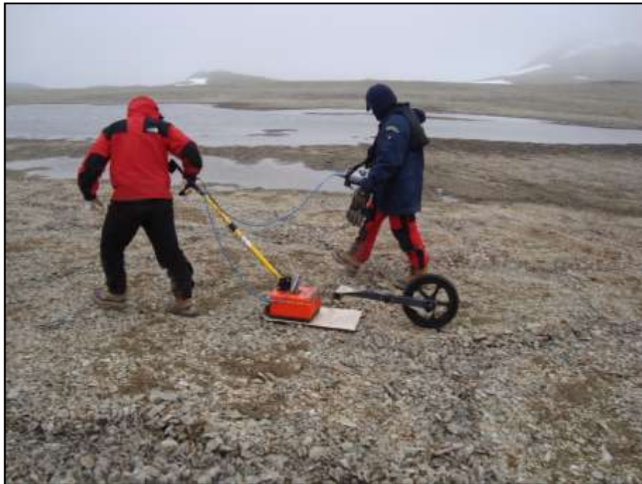
Figura 3. Varredura do solo com padrões com aparelho GPR.
