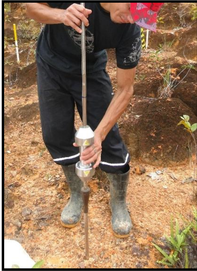
Figura 6. Resistência do solo à penetração de raízes – Penetrômetro de impacto, modelo Daiki. UHE Balbina, AM.
