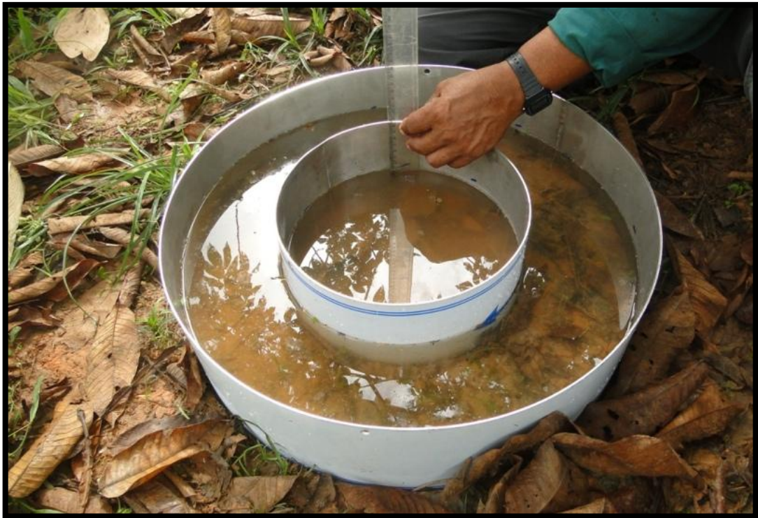
Figura 5. Medição da taxa de infiltração do solo – anéis concêntricos, régua e cronômetro utilizados para a coleta. UHE Balbina, AM.
