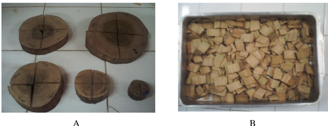
Figura 2 – A) Discos subdivididos em quatro partes em forma de cunha, passando pela medula, B) Cavacos preparados para estudos posteriores
