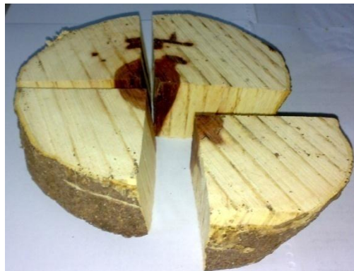
Figura 2 – Fracionamento de um disco de madeira para determinação da densidade
